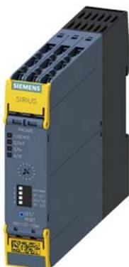
Предохранительное устройство SIRIUS Базовое устройство серии Advanced с задержкой 0,05–3 с электронные цепи размыкания 2 НО, без задержки 2 НО, с задержкой  $U_s = 24$  В DC Винтовой зажим
