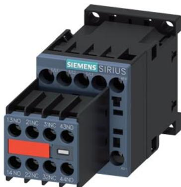
Силовой контактор, AC-3 16 A, 7,5 кВт/400 В 2 НО + 2 НЗ, 24 В DC 3-пол., типоразмер S00 винтовая клемма несъемный вспомогательный выключатель
